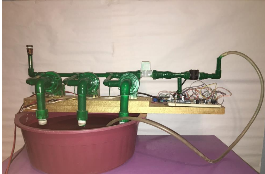
Imagen 4-17. Vista frontal del prototipo de un sistema automático de distribución de agua.
