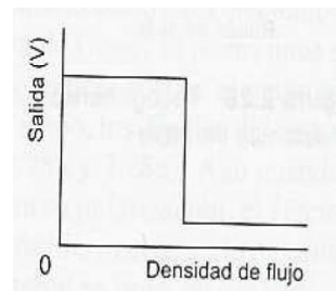
Imagen 3-6. Sensor de efecto Hall de tipo Umbral
